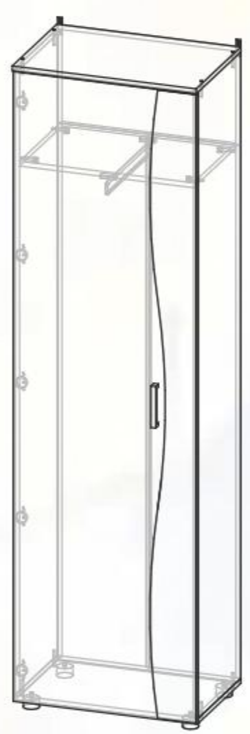
«Юнона-1 шкаф» Д600хВ2110хГ403 мм
